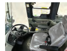
Coluna de direção com ajuste de altura e rebatimento. Assento ajustável com amortecimento bidirecional, apoio de braço e para trabalho.
